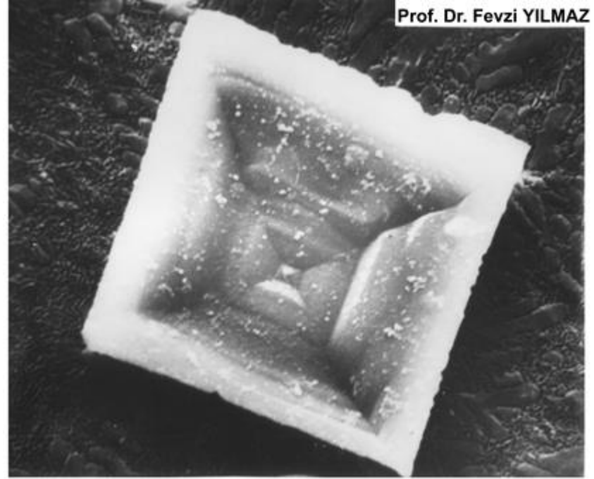
Parlatılmış ve dağlanmış Si kristali, {100} düzlemi (SEM görüntüsü) 10 μm
