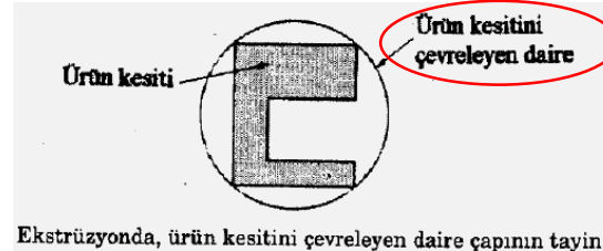
Ekstrüzyonda, ürün kesitini çevreleyen daire çapının tayini.
